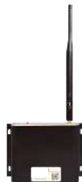
Conexão via 3G*** O Gateway de conecta a nuvem via rede de celular
